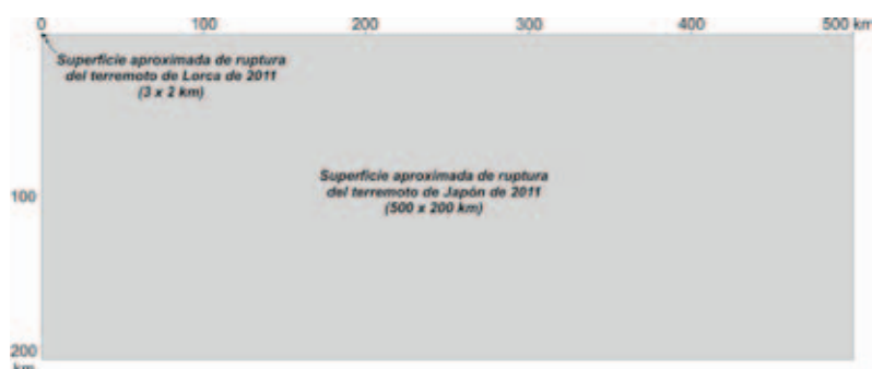
Fig. 9. Esquema comparativo entre la superficie de ruptura aproximada producida por los terremotos de Lorca y Japón de 2011.
