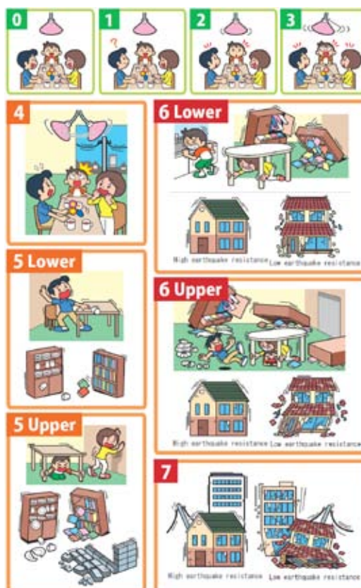
Fig. 3. Imágenes que resumen la escala de intensidad japonesa (JMA). http://www.jma.go.jp/jma/en/Activities/earthquake.html
